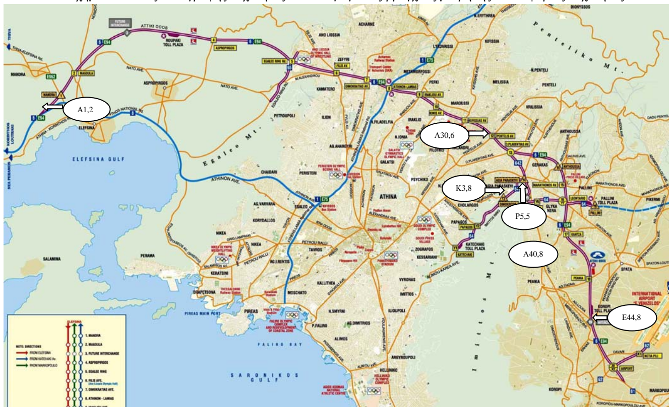
Σχήμα 1: Θέσεις καταγραφής ταχύτητας από επαγωγικούς βρόγχους μέτρησης κυκλοφορίας/ταχύτητας
